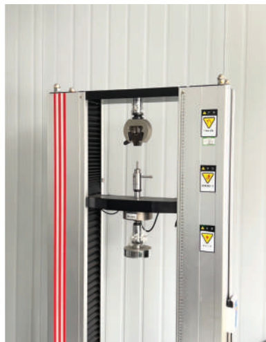
Установка для испытаний на разрыв
