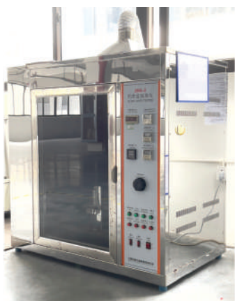
Установка для испытаний нитью накала
