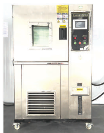
Камера высоких и низких температур
