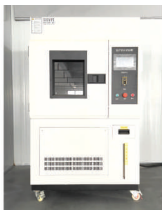
Камера для испытания на старение ксеноновой дугой
